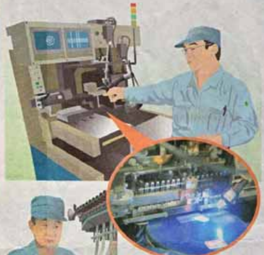
▲青いシートに張り付けられたLEDチップがリードフレームに束を。とってもマイクロな世界
